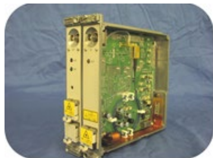
光変換部 (E/O・O/E)
