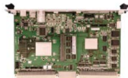
高周波フロントエンド回路搭載汎用FPGAボード
